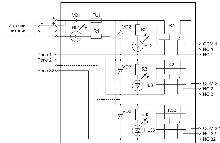
Рисунок 1 — Функциональная схема модулей исполнения «24DC(+)»
