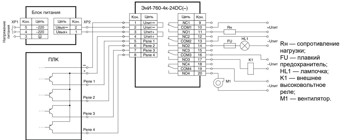
Рисунок Б.2 — Схема подключения ЭНИ-760 исполнения «24DC(–)»
