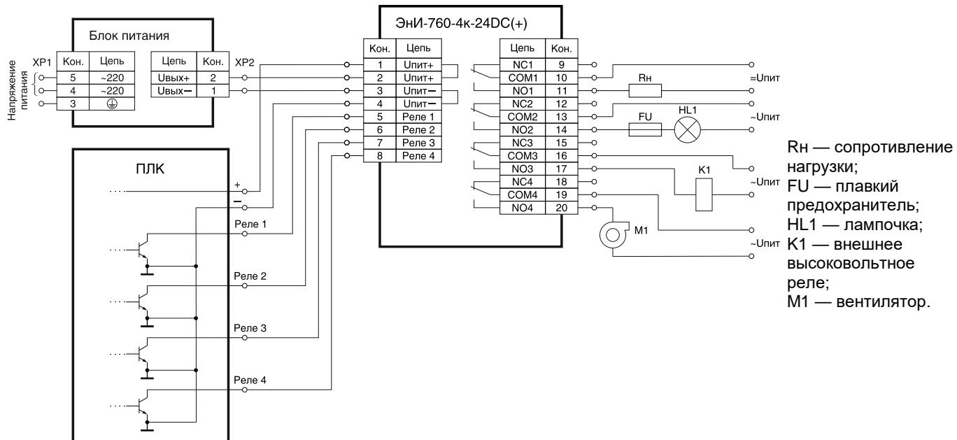
Рисунок Б.1 — Схема подключения ЭНИ-760 исполнения «24DC(+)
