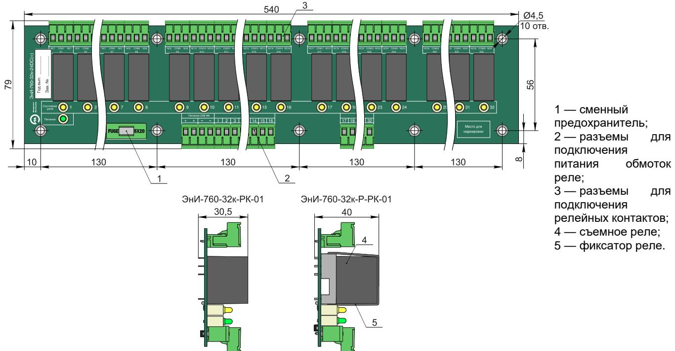
Рисунок А.16 — Габаритные размеры модулей ЭНИ-760-32к-РК-01
