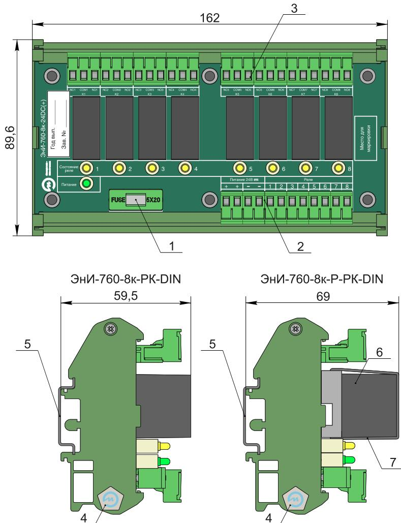
Рисунок А.6 — Габаритные размеры модулей
