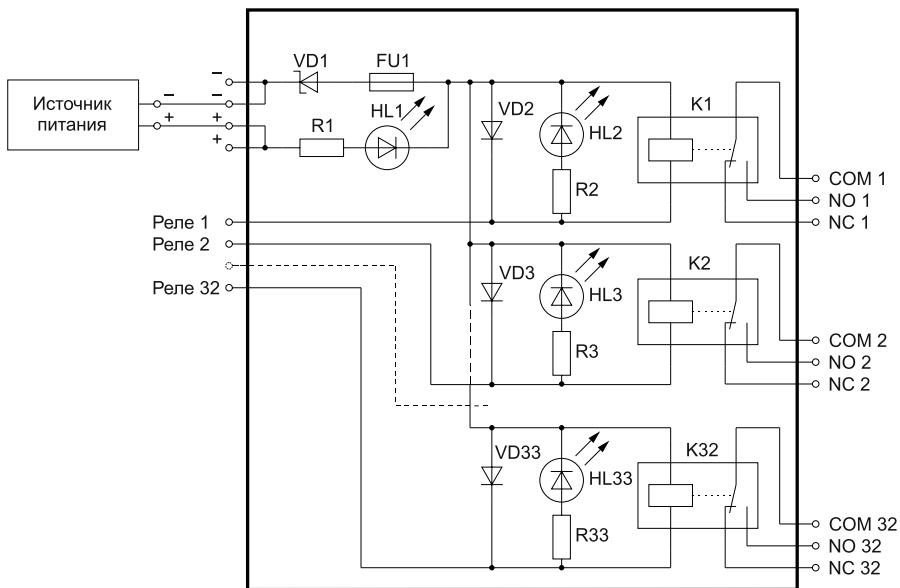
Рисунок 2 — Функциональная схема модулей исполнения «24DC(–)»
