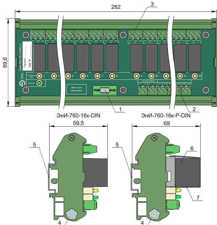
Рисунок А.9 — Габаритные размеры модулей ЭИ-760-16к-DIN
