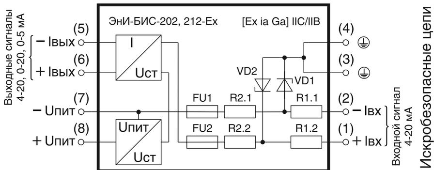
I/Uст — преобразователь напряжения в ток, формирующий выходной ток-овый сигнал;
