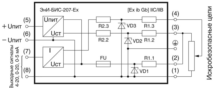
I/Уст — преобразователь напряжения в ток, формирующий выходной токовый сигнал;
